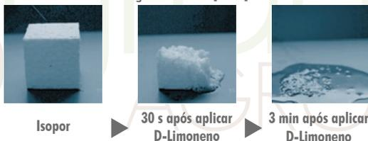
Dessa forma, qualquer produto que for dotado de um solvente capaz de dissolver o isopor irá se sair muito bem no teste. Só que isso **não tem utilidade para averiguarmos o potencial desse adjuvante como penetrante**. Infelizmente não há teste prático e rápido que nos garanta isso, apenas testes em laboratório ou estudos de campos realizados em centros de pesquisa.
